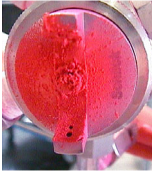
Anbackproblematik bei der herkömmlichen 2-Stoff-Flachstrahldüse mit „Hörnerkappe“ ohne ABC-Technik
