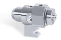
SCHLICK 650 7-1 S40系列是压力式糖衣包衣喷嘴,雾化形状为扇形,通过更换尾部喷芯,即使整雾化流量和雾化角度,即使液体有压力的情况下,喷芯也可能直接更换,此系列喷也可批款加热护套,喷嘴在加热护套中的位置可转动调整。
