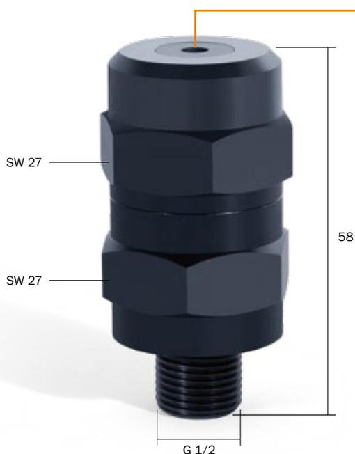
**118**系列喷嘴材质为硬质合金, 雾化形状为空心锥, 特别适用于要求雾化液滴小的场合, 喷芯和涡流腔也是由硬质合金制成(可选光面或者雾面), 通过更换喷芯, 可获得不同流量和雾化角度。
