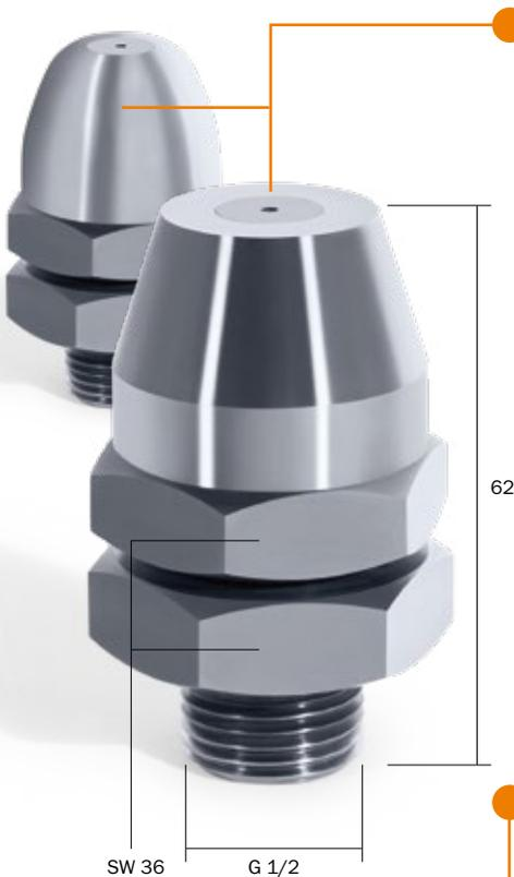
**432**系列喷嘴材质为硬质合金,一般用于喷雾干燥,喷芯和涡流腔也是由硬质合金制成(可选光面或者雾面),**432**系列喷嘴流量特别大,是通过涡流腔中相切的两个圆孔来实现的,喷芯孔径可选:  $\varnothing 0.5$ - $\varnothing 6.0$ mm (以 $0.1$ mm递增)。为防止物料在喷嘴前端堆积,**432**系列有前端圆弧处理的定制款。
