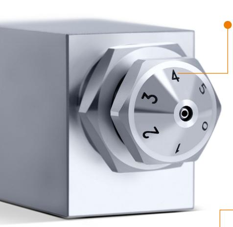
标有刻度的空气帽可精确调整雾化气体的流量,根据应用的不用,需要反复试验确定风帽的位置。
