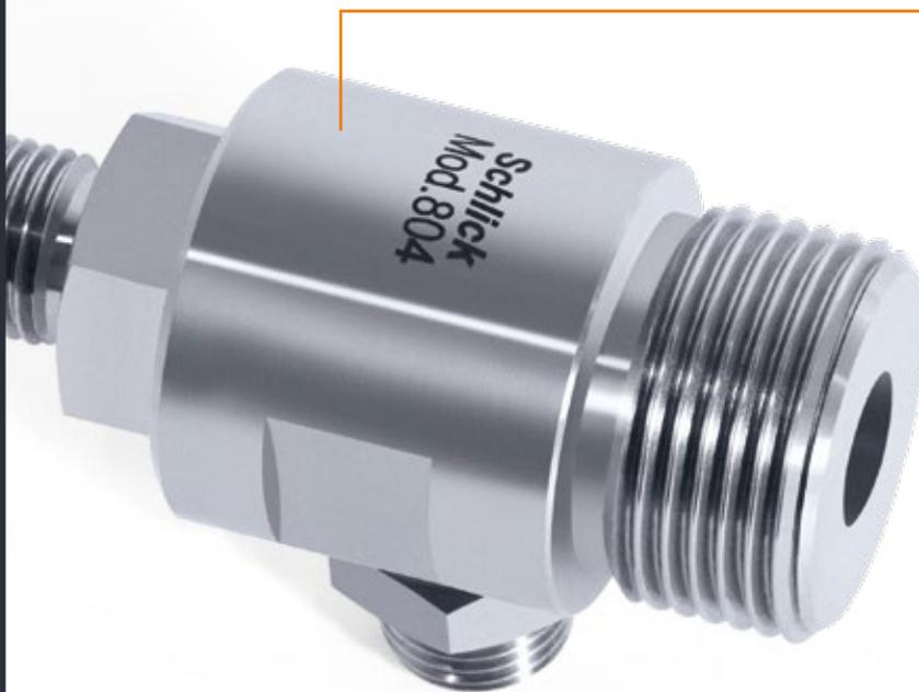
Die SCHLICK Injektordüse Modell 804 mit zentrischem Anschluss für das Treibmedium. Für das zweite Medium steht ein zusätzlicher seitlicher Anschluß zur Verfügung. Die Mischung der Medien erfolgt innerhalb der Düse.
